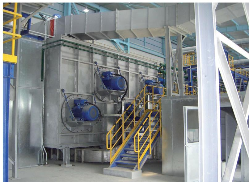
**Bild 4: Kühlanlage mit "hot cooling zone" hinter dem Glühofen**
